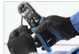
A nagy precíziós sajtolópofák a szorítóhüvelyt mindig pontosan a megfelelő formára préselik.
